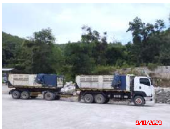
รูปที่ 10 การใช้ผ้าใบปิดคลุมกระบะรถบรรทุก
