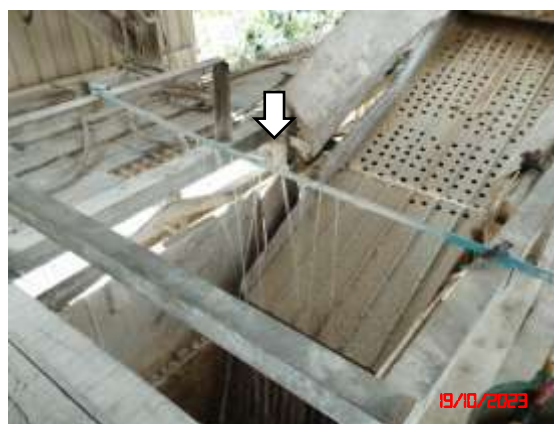
ระบบสเปรย์น้ำบริเวณกำเนิดฝุ่นละออง
