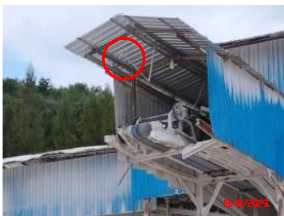
ระบบสเปรย์น้ำบริเวณกำเนิดฝุ่นละออง
